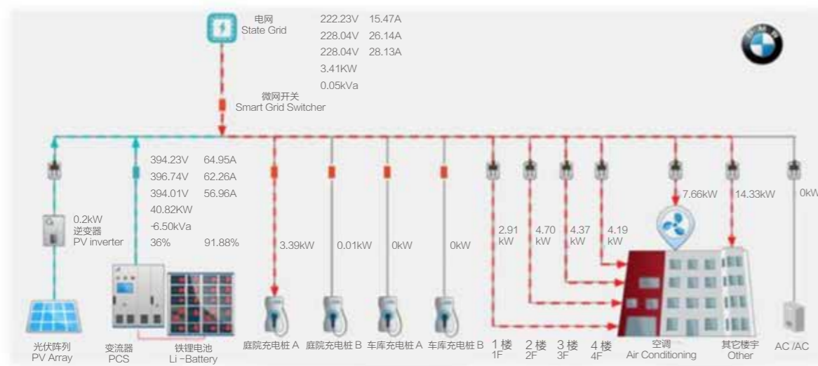
图 4-7 上海宝马互联驾驶研究院电动汽车及储能项目框架示意图
